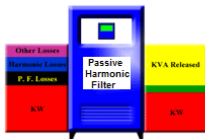
شکل ۶: افزایش و آزاد سازی ظرفیت دیماندر و توان مصرفی اکتیو، راکتیو و ظاهری با فیلتر پسیو
